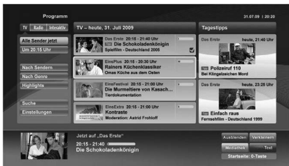
Εικόνα b: Εφαρμογή EPG. Το εκπεμπόμενο βίντεο εμφανίζεται κάτω αριστερά, μπορεί να τερματιστεί πιέζοντας 0.
